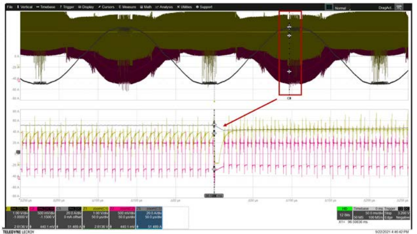
図5. 位相電流、レッグ電流の検出信号、およびOCpn信号。スイッチング周期中の実験波形と拡大図。C5の灰色 20\text{A/div} は外部電流プローブで測定された位相電流、C1の黄色 1\text{V/div} はOCpn、C2のピンク色 500\text{mV/div} は増幅されたレッグ・シャント電流信号です。 t=50\text{ms/div} 、拡大図 t=50\mu\text{s/div} 。
